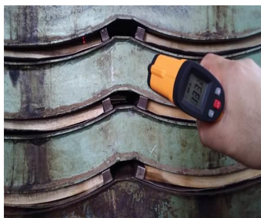
Hình 4. Kiểm tra nhiệt độ quá trình uốn gỗ
