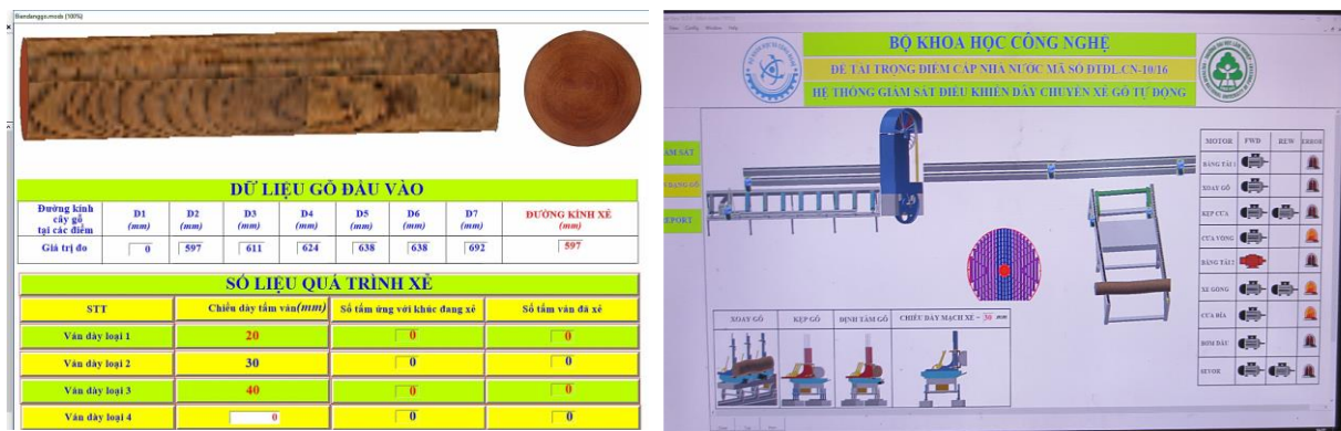
Hình 2: Giao diện của chương trình điều khiển dây chuyền xẻ gỗ tự động
