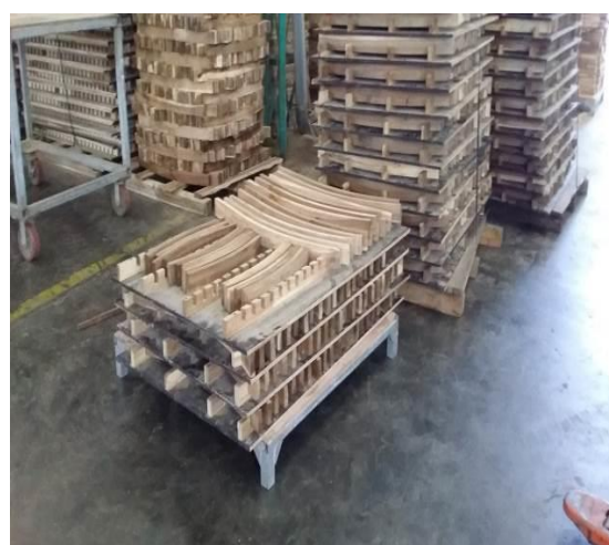
Hình 6. Gắn gỗ uốn vào giá định hình
