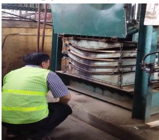
Hình 3. Uốn gỗ kết hợp sấy định hình
